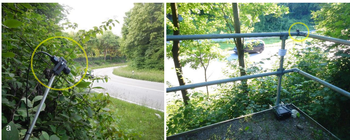
Abb. 2: Horchboxstandorte (Mikrofone gelb markiert) (a) am Zubringer Ost und (b) am Föhringer Ring
